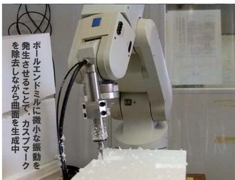
CAD/CAMベースの加工ロボット
