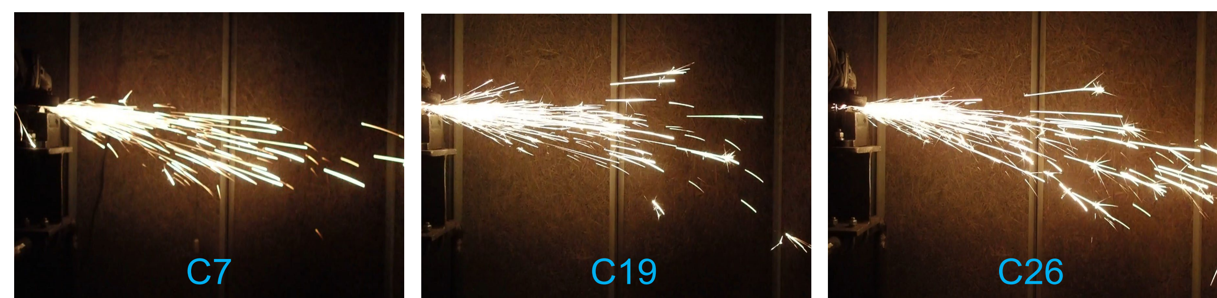
図3 3D CNNによる金属の火花試験時の炭素含有量の推定
